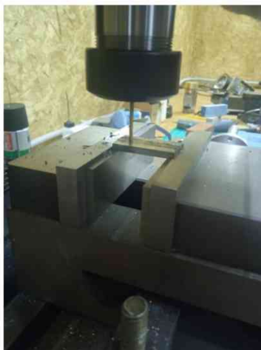
ФОТО 7. ИЗГОТОВЛЕНИЕ БОЛЬСТЕРА (ГАРДЫ).
