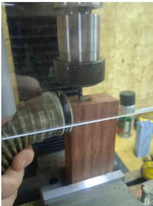
ФОТО 9. ОТВЕРСТИЕ ДЛЯ ВХОДА ХВОСТОВИКА КЛИНКА.
