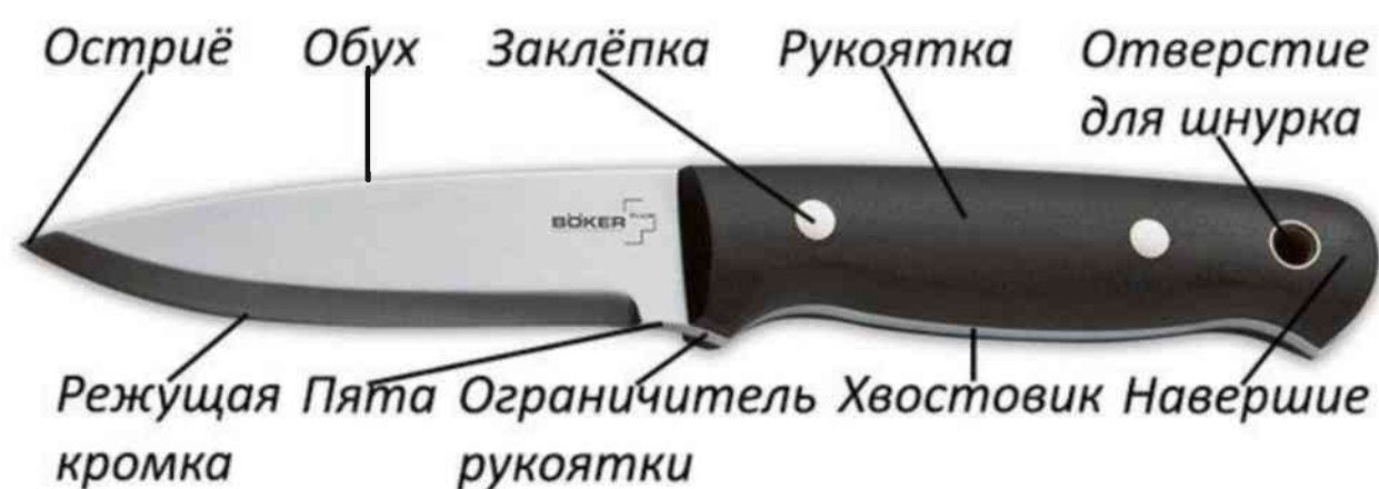
Рисунок 2. Составные компоненты ножа.
