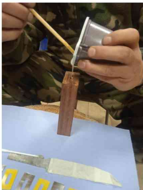
ФОТО 11,12. СКЛЕИВАНИЕ КОМПОНЕНТОВ МЕЖДУ СОБОЙ.
