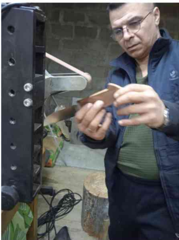
ФОТО 13 и 14. ДОРАБОТКА И ПОЛИРОВКА РУКОЯТИ
