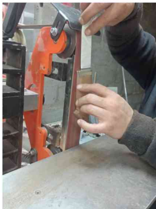
ФОТО 15 и 16. ДОРАБОТКА И ПОЛИРОВКА РУКОЯТИ
