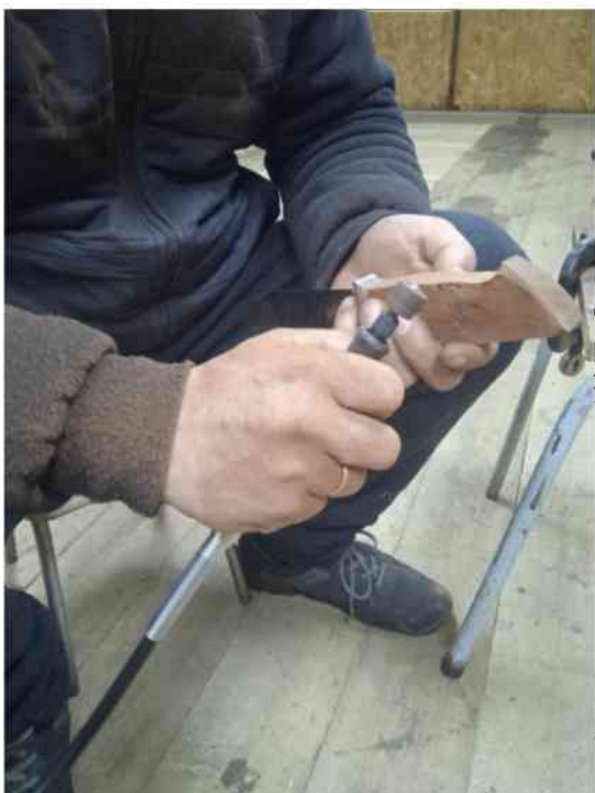
ФОТО 15 и 16. ДОРАБОТКА И ПОЛИРОВКА РУКОЯТИ
