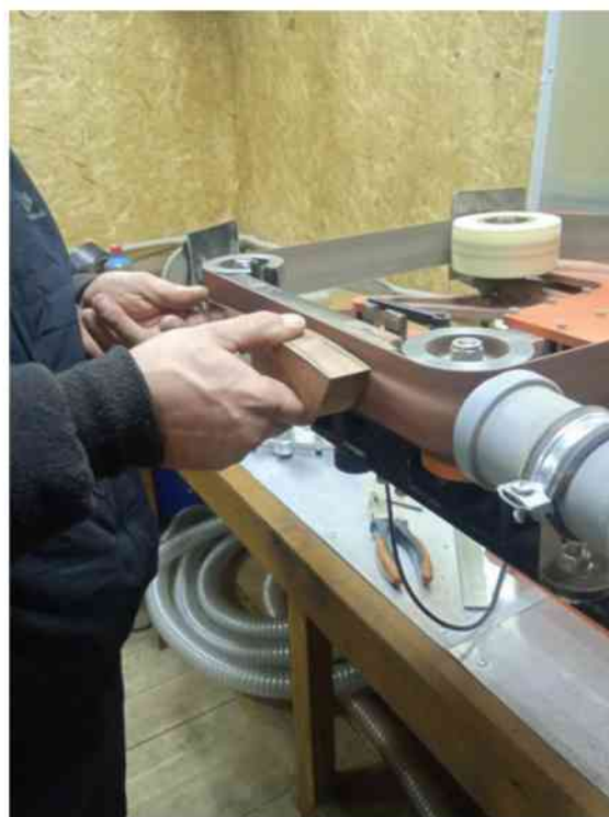
ФОТО 13 и 14. ДОРАБОТКА И ПОЛИРОВКА РУКОЯТИ
